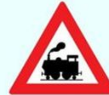
VZ24 Bahnübergang ohne Schranken
